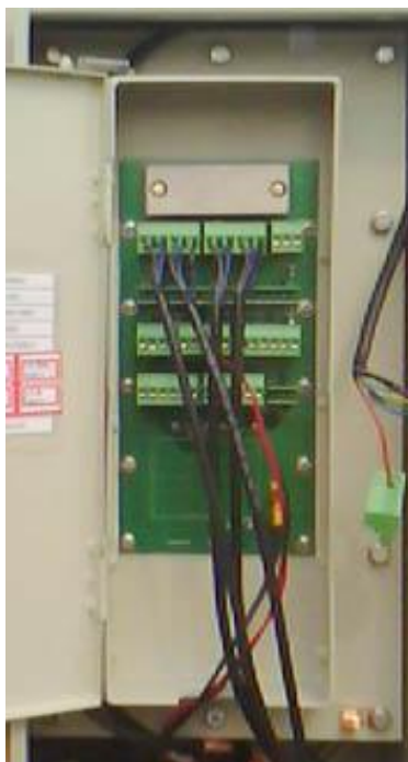
图 20 连接传感器信号线
